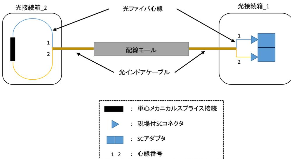
図 2 光ファイバ心線接続図
